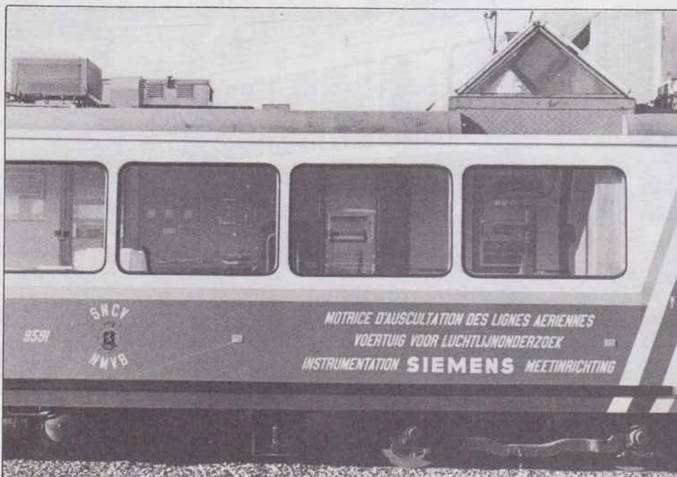
Zijaanzicht van het NMVB-SIEMENS voertuig voor luchtlijnonderzoek 9591. Merk de observatiekoepel op het dak. Stelplaats Jumet, 12.84.
