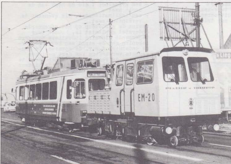
Plasser & Theurer 9594 (met de duidelijk zichtbare opgetrokken meetassen) gekoppeld met de 9591. Jumet, Chaussée de Bruxelles, 12.84.
